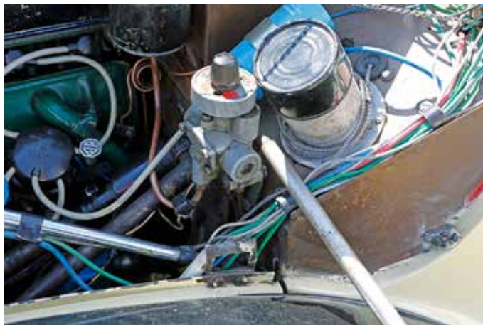
I händelse av punktering finns en inbygg domkraft för alla fyra hjulen.
