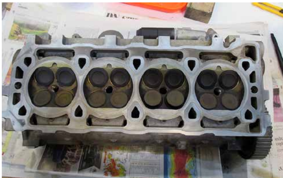
Ett par av silikonsträngarna på packningen hade släppt (ovan). Cylindertoppen var felfri.
