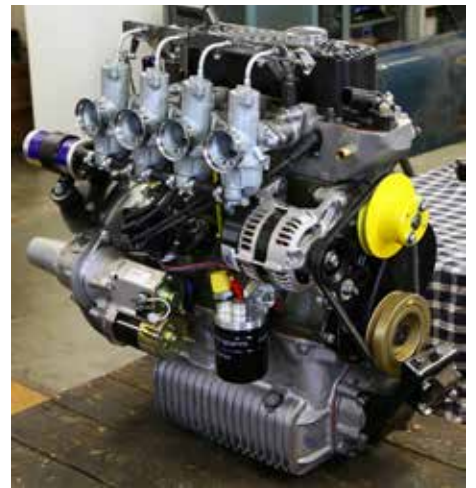
Ardentoppen monterad på Kjells hundkojemotor. Matas av fyra st Amal mc-förgasare.
