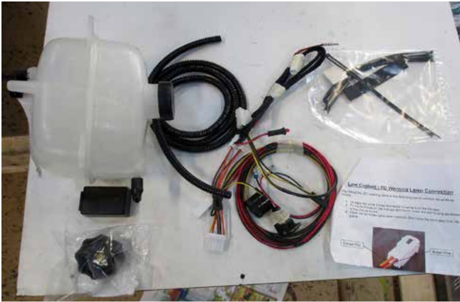
Det nya expansionskärlet med nivåalarm.
