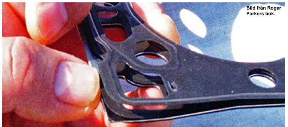
Den nya "multi-layer-packningen" består av fem lager i stället för ett som originalet har.
